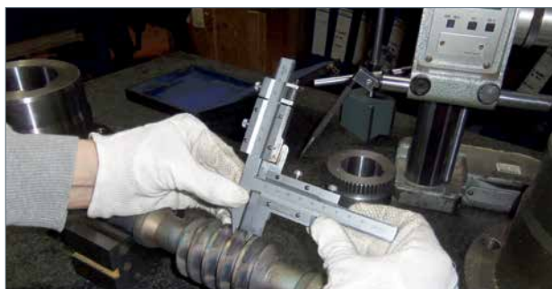
游标齿厚规检测齿轮尺寸
