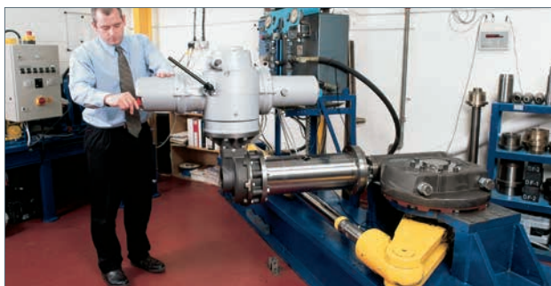
齿轮箱（样品）寿命测试
