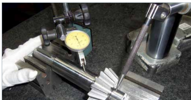
带刻度盘指示器同心度测试
