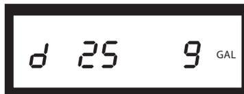
Figura 15: tipo de medidor, resolución de dígitos del codificador y unidad de medida
