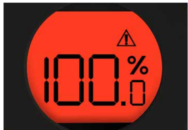
図 5.7 電源の故障時には、アクチュエータは赤・白交互に点滅します
