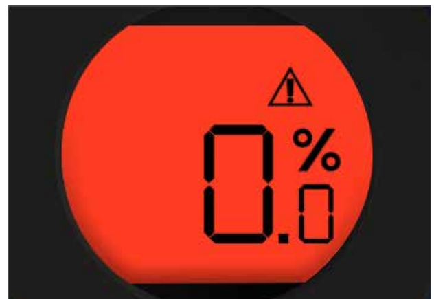
図 9.3 故障中にRPPが作動しているとディスプレイが赤と白に点滅します。
