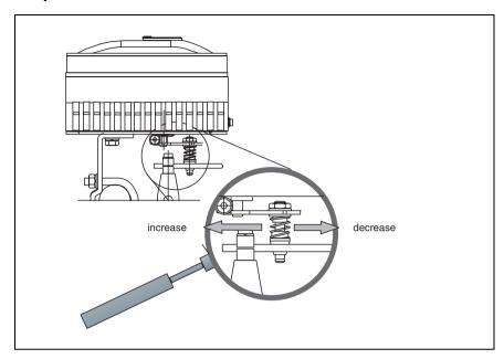
Fig. 10 Positioner linkage
