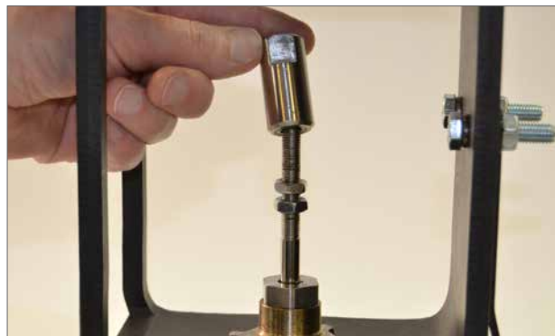
Рис. 6.4 Установка втулки на шток арматуры
