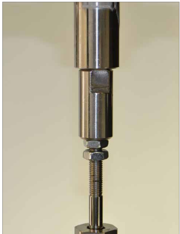
Рис. 6.7 Соединение штока арматуры и штока привода
