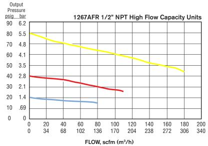
0-120 psig (0-8.3 BAR); 150 psig (10 BAR) supply ■ 0-60 psig (0-4.1 BAR); 100 psig (6.9 BAR) supply ■ 0-30 psig (0-2.1 BAR); 100 psig (6.9 BAR) supply
