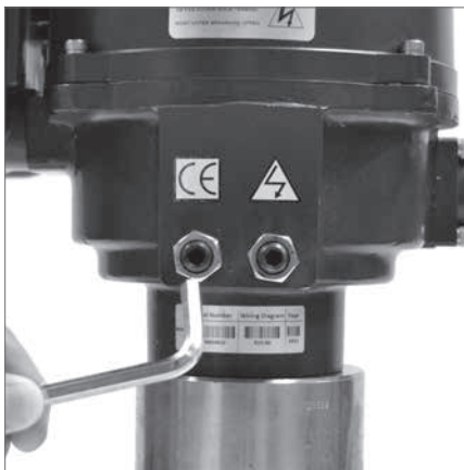
Регулировка стопорного болта для закрытия против часовой стрелки
