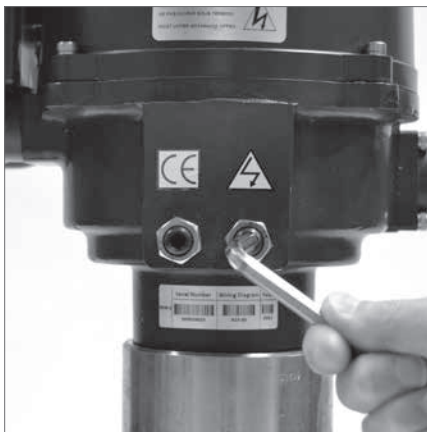
Регулировка стопорного болта для закрытия по часовой стрелке
