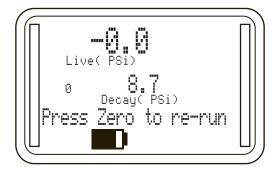
DECAY LEAK TEST CONT.
