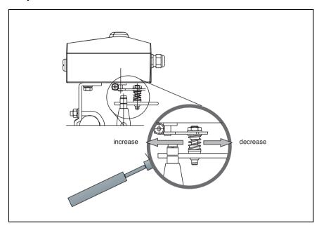
Fig. 10 Positioner linkage
