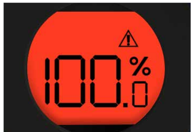
Fig. 15.2 El actuador parpadeará alternando los colores rojo y blanco si se produce un corte del suministro eléctrico.
