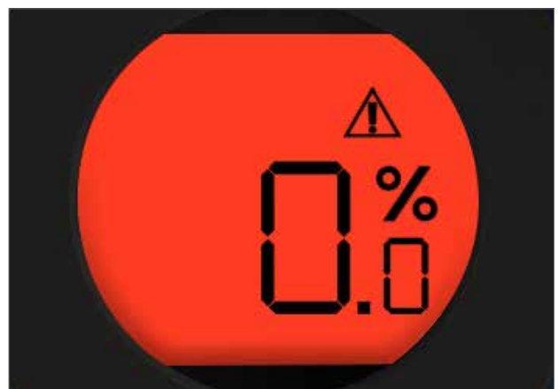
Fig. 25.2. El actuador parpadeará alternando los colores rojo y blanco cuando el grupo de alimentación de reserva se active durante un corte del suministro eléctrico.
