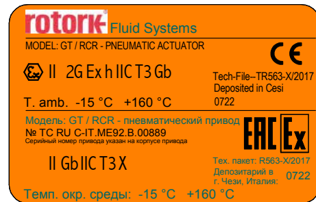
Fig. 5.3 Etichetta attuatore ATEX/EAC per alta temperatura (-15°C<T<+160°C)
