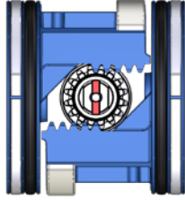
Fig 10.2 조립 A - 시계방향으로 액추에이터 달기 액추에이터 바디와 수직인 상부 샤프트
