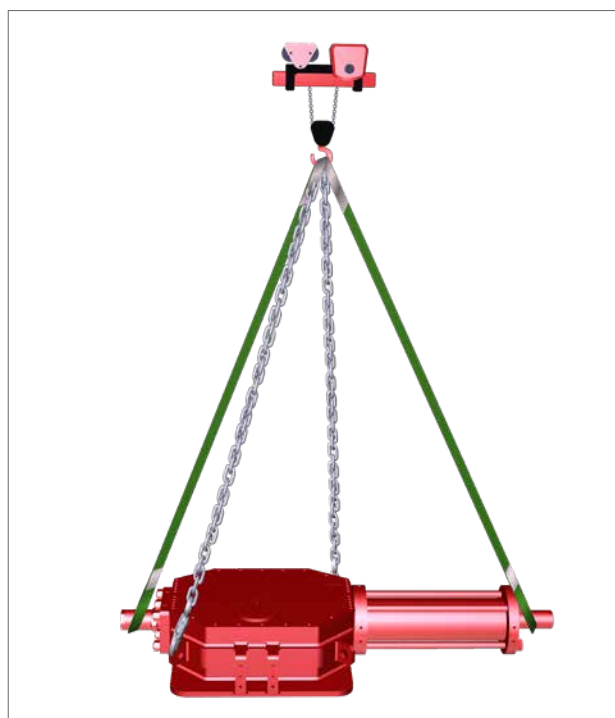
Рис. 7.4 Подъём (привода двустороннего действия размера 200 - 350)
