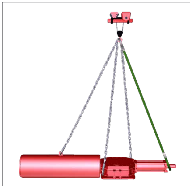
Рис. 7.3 Подъём (привода одностороннего действия размера 200 - 350)
