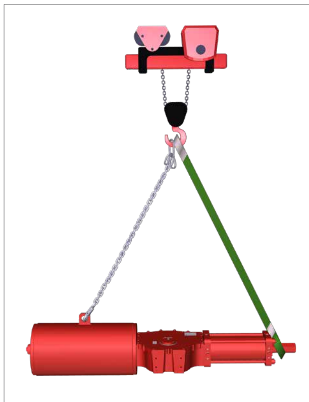
Рис. 7.1 Подъём (привода одностороннего действия до размера 161)
